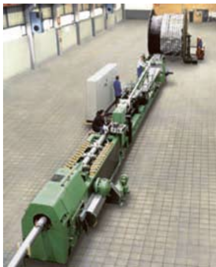
Produkcja izolowanego próżnią rurociągu CRYOFLEX® do kabla HTS
